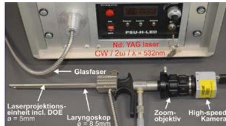
Miniaturisierter Aufbau zur 3-D-Rekonstruktion der Stimmlippenoberfläche aus In-vivo-Hochgeschwindigkeitsaufnahmen. Quelle: Marion Semmler/Uni-Klinikum Erlangen
