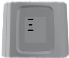
Linien links in der Anzeige: Soundprozessor wurde für das linke Ohr programmiert
