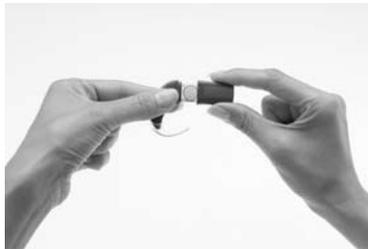
4. Setzen Sie die Batterieabdeckung wieder auf. Schieben Sie sie dazu vom Boden des Batteriehalters in Richtung der Soundprozessor-Einheit. Drücken Sie die Abdeckung nicht mit Gewalt nach oben. Sie sollte problemlos passen.
