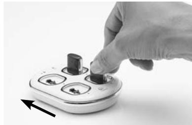
3. Drehen Sie das Akkumodul im Uhrzeigersinn, bis es auf die Markierung am Ladegerät ausgerichtet ist.
