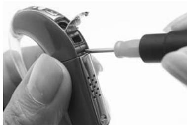
1. Öffnen Sie die Schutzabdeckung des Zubehöranschlusses Ihres Soundprozessors, um an den Verriegelungsmechanismus zu gelangen. Er befindet sich unterhalb des Zubehöranschlusses.
