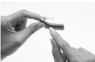
3. Überprüfen Sie, ob das Batterie- bzw. Akkumodul ordnungsgemäß ausgerichtet ist. Überprüfen Sie den Bereich zwischen Batterie- bzw. Akkumodul und Soundprozessor-Einheit auf abgebrochene oder verbogene Kontakte, die eine fehlerhafte Ausrichtung verursachen können. Wenn Kontakte beschädigt sind, wenden Sie sich an Ihren Audiologen oder den Cochlear™ Service.
