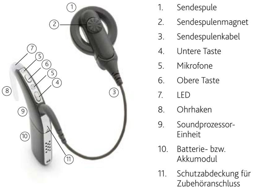
Abbildung 1: Teile des CP810 Soundprozessors
