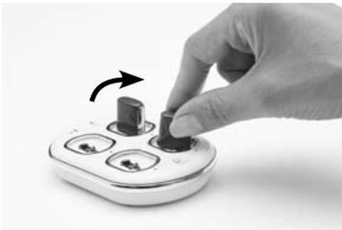
2. Setzen Sie das Akkumodul, wie abgebildet, in die Buchse des Ladegeräts ein.
