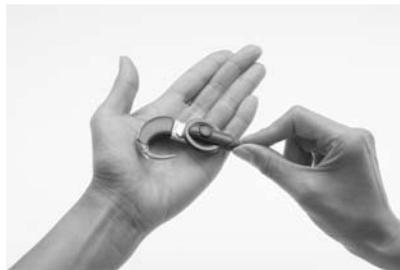
1. Halten Sie die Sendespule so über die Batterien, dass der Sendespulenmagnet die Batterien berührt. Dadurch werden beide Batterien vom Magneten angezogen und aus dem Batteriefach herausgehoben.
